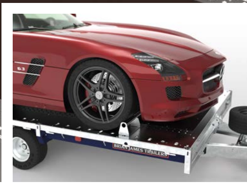
Aanrijdblokkering Verstelbare aanrijdblokkering over de volledige laadvloer lengte toe te passen.
