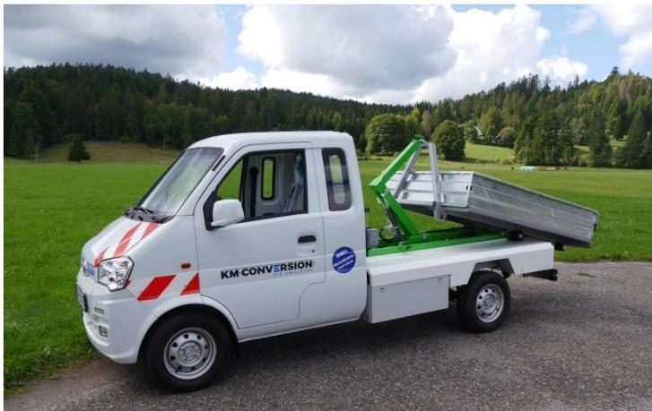
Der Abrollkipper AR-L 10-0 ist speziell für sehr kleine Fahrzeuge konzipiert. Mit seinem Eigengewicht von nur ca. 130 kg und einer Hubkraft von ca. 1.000 kg haben wir den ersten Prototyp auf einem Elektrofahrzeug aufgebaut. Die Zielgruppe für Fahrzeuge dieser Art ist vor allem die innerstädtische Reinigung, bei der meist eingeschränkte Platzverhältnisse herrschen und Verbrennerfahrzeuge immer unbeliebter werden.
