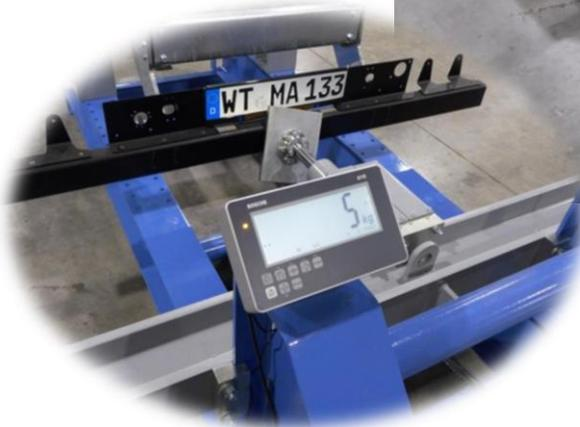
Mit unserem neuen Unterfahrschutz-Prüfstand haben wir die Möglichkeit, im eigenen Werk alle Unterfahrschutze zu prüfen. Wir können die vorgeschriebenen Prüfkräfte gezielt auf die Bauteile ausüben und somit die vorab berechneten Konstruktionen nach den neusten Vorschriften überprüfen.
