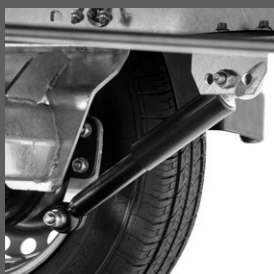
Wielschokdemper gemonteerd incl. 100 km/h bevestiging
