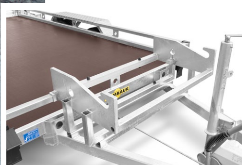
Graafbak rust standaard op V-drawbar
