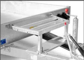
Opvouwbare graafmachinesteun voor V-trekhaak
