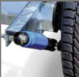
Wheel shock absorbers (standard on some models) Amortisseur de roues (en partie de série) Wielschokdempers (deels standaard)
