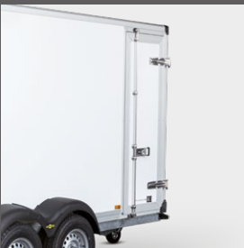
Zijdeur met draaistangsluiting vanaf binnenhoogte 1500 - 2300 mm
