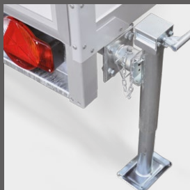
Telescopische draaislinger voor gesloten aanhangwagens (2 stuks)
