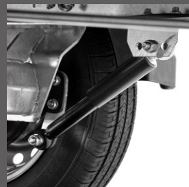
Wielschokdemper (gemon-teerd) incl. 100 km/h goed-keuring Wielschokdemper (los) zonder 100 km/h goedkeuring
